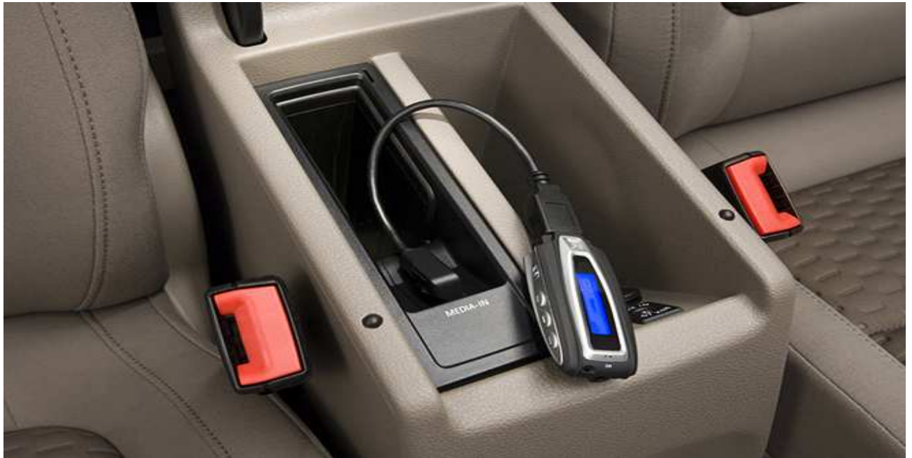
Multimedia-Schnittstelle MEDIA-IN (im Foto: USB-Adapter)
