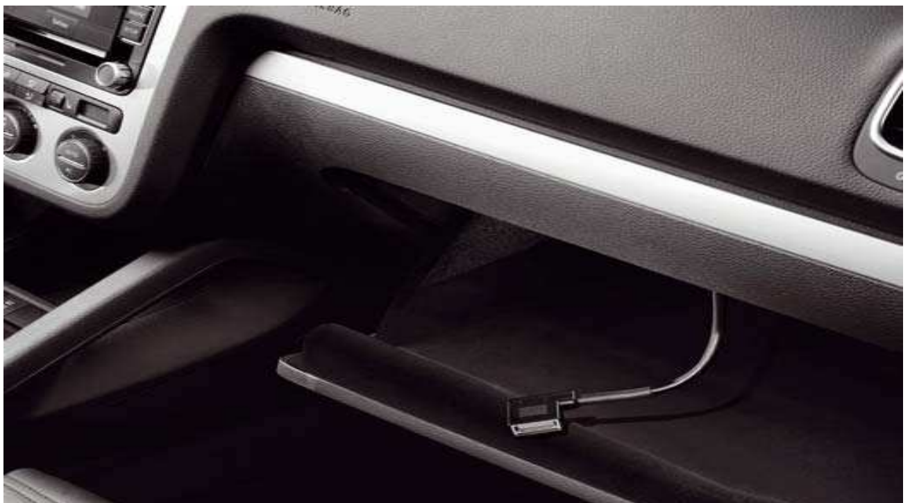
Multimedia-Schnittstelle MEDIA-IN (im Foto: USB-Adapter)
